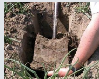
6. Steek een kluit uit de ondergrond van 25 tot 50 cm diepte en beoordeel deze
